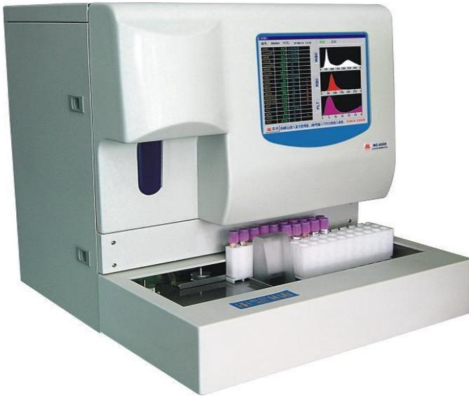
*Hematology analyzer* merupakan alat yang digunakan untuk mengukur dan memeriksa sel darah dengan lengkap secara otomatis berdasar impedansi berkas cahaya atau aliran listrik. Alat ini dapat membantu dalam mendiagnosis penyakit yang mungkin diderita pasien seperti diabetes, kanker dan lain sebagainya. *Hematology analyzer* dapat membantu mendiagnosa suatu penyakit secara akurat
