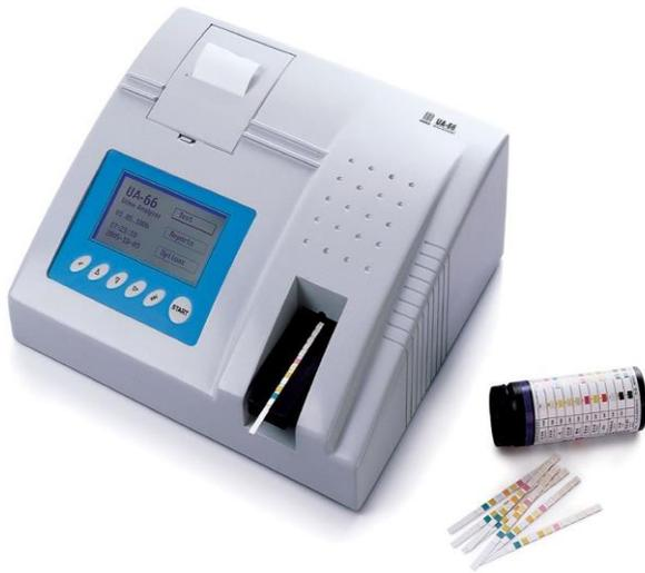
*Urine analyzer* adalah alat yang digunakan untuk mengevaluasi dan membaca hasil dari strip test urine. Alat ini bekerja dengan semi otomatis dalam pengecekan yang dilakukan pada luar tubuh, yang hasil pengecekan urinenya selalu tepat. Strip tes urine ini dilakukan ketika ingin mengetahui leukosit, pH, berat jenis, protein, glukosa, dan lain sebagainya.
